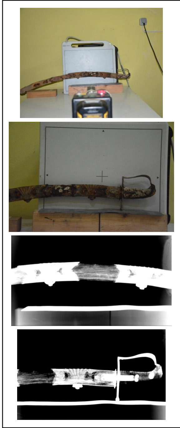
Resim 9: Flat panel platformu ve elde edilen görüntüler.
