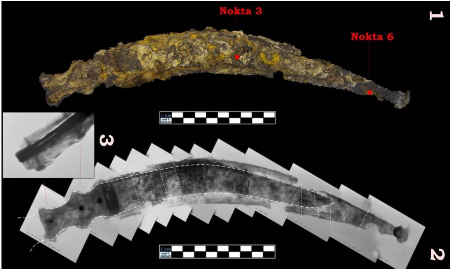
Şekil 5: BKM-M1 kodlu örneğin X-ışını radyografi görüntüsü ve üzerinde görülen anomaliler (MAKLAB Arşivi).
