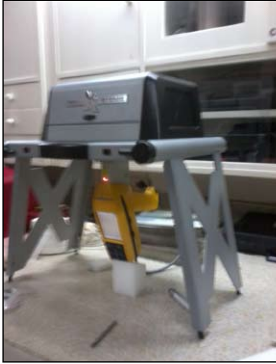
Resim 5: Taşınabilir X Işını Floresansı Spektrometresi (INNOV-X-SYSTEM Dalgaboyu Dağılımlı Taşınabilir Omega X Işını Floresansı Spektrometresi)* 12
