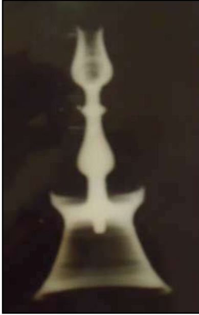
Resim 2: Buhur-şamdanın X-ışını radyografı
