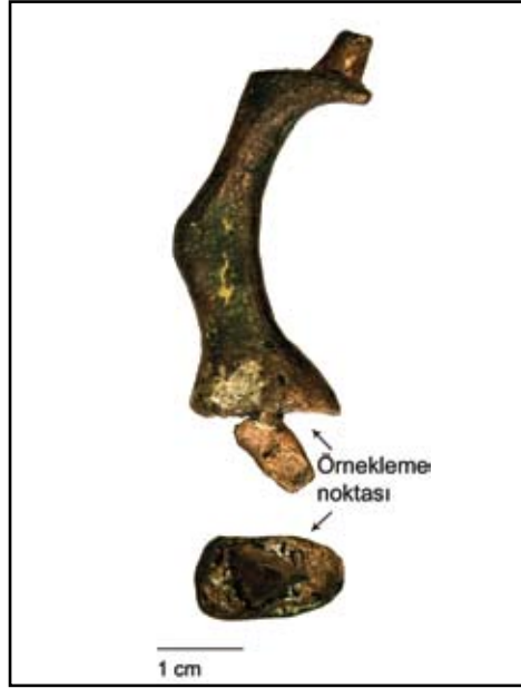
Resim 3: Dökme Cu-As alaşımı figürin ve sapları (BO77.385B). Figürinin ayak kısmının gümüşlenmiş dış yüzeyi korunmuştur.
