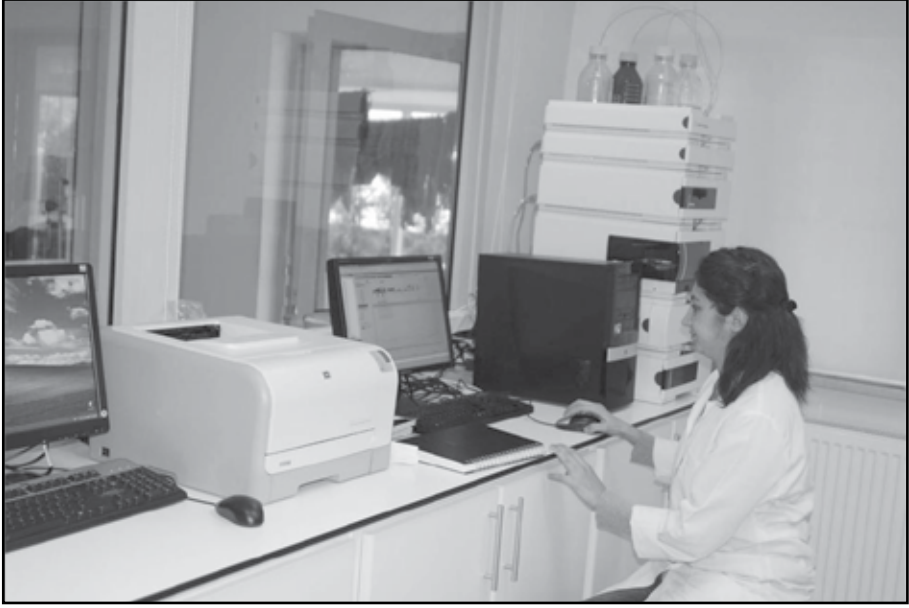
Şekil 2: Türk Kültür Vakfı, Kültürel Miras ve Doğal Boya Laboratuvarı yüksek performanslı sıvı kromatografi cihazı (HPLC).
