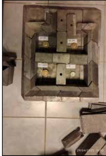
Resim 4: Beta doz hızının belirlenmesi için kurşun zırh içine yerleştirilen sıva ve kerpiç örneklerinin üzerine yerleştirilen ince Al_2O_3:C dozimetrelerin deney geometrisi
