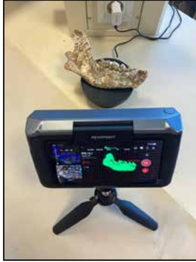
Resim 11: Üç boyutlu yüzey tarayıcı ile fosillerin üç boyutlu görüntülerinin alınması.
