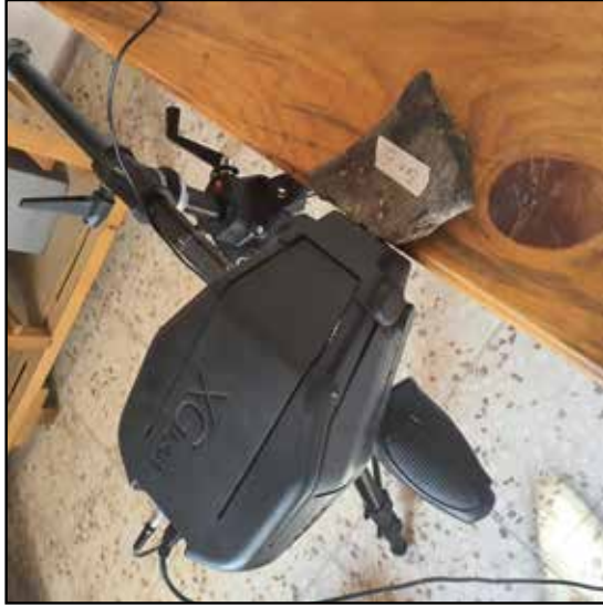
Resim 3: Taşınabilir X-ışını floresans spektrometresi (pXRF) (A. Mantovan).
