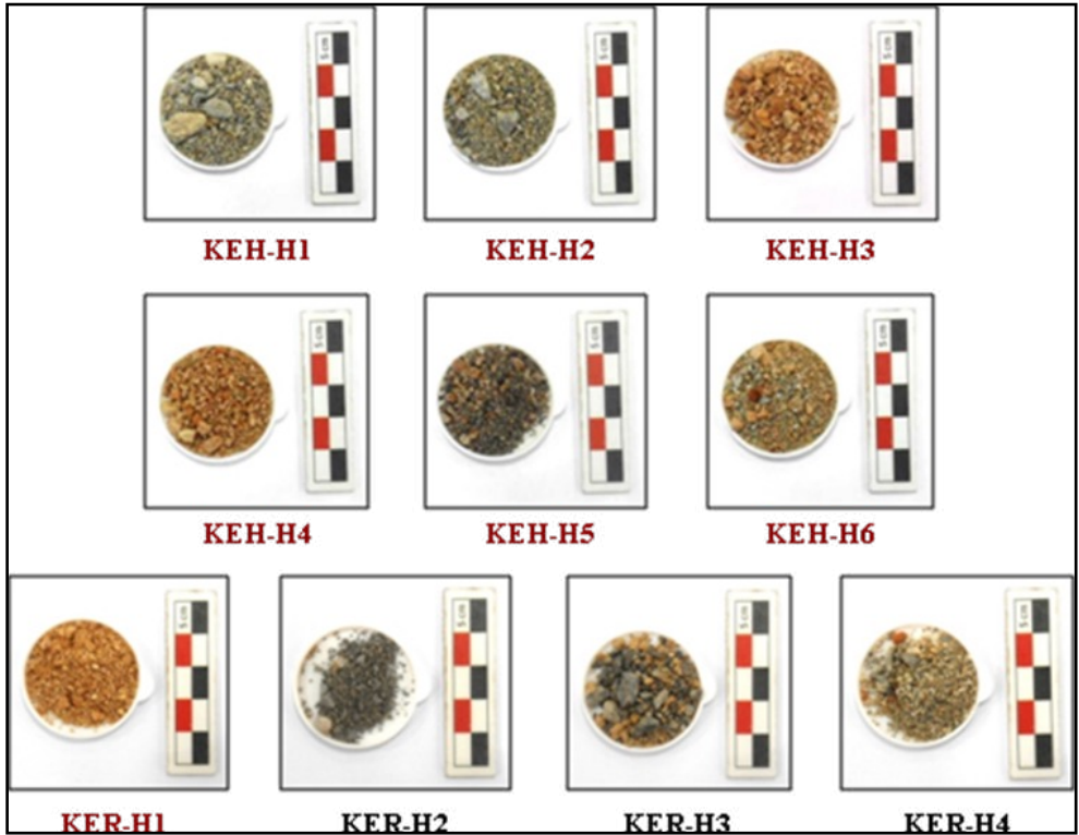
Şekil 6: Keramos Antik Kenti yapılarına ait Roma Hamamı'na ait harç örneklerinde toplam agrega/bağlayıcı oranları (MAKLAB Arşivi)
