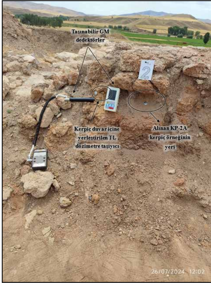
Resim 3: 2 No.lu Alan'dan alınan kerpiç örneği ve yerleştirilen dozimetrenin gösterimi
