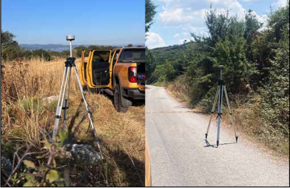
Resim 1: CORS GNSS arazi kontrol noktası okumaları (Parion Kazı Arşivi)
