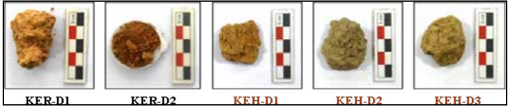
Şekil 5: Keramos Antik Kenti yakın çevresinde bulunan akarsu yatağına ait toprak/kil örnekler (MAKLAB Arşivi)
