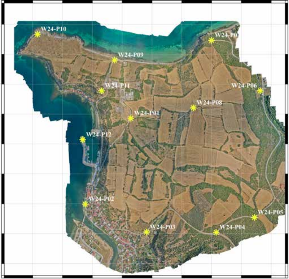
Resim 3: Parion Antik Kenti ortofotosu ve belgeleme için konumlandırılmış yersel kontrol noktaları (Parion Kazı Arşivi)
