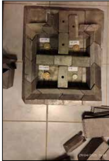
Resim 4: Beta doz hızının belirlenmesi için kurşun zırh içine yerleştirilen sıva ve kerpiç örneklerinin üzerine yerleştirilen ince \text{Al}_2\text{O}_3:\text{C} dozimetrelerin deney geometrisi
