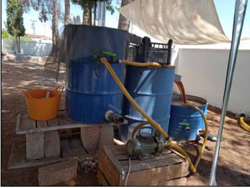
Resim 2. Devridaimli yüzdürme (flotasyon) sistemi.
