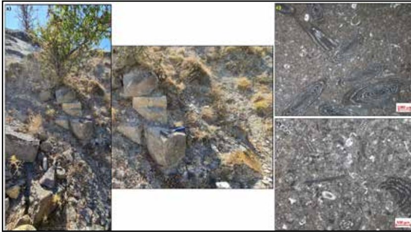
Resim 8. Karalar-Asarkaya duvar yapılarında bulunan biyosiparitik (fosilli) kireçtaşı kayasının makroskobik görüntüsü (a-b), bol miktarda farklı fosilleri içeren kayanın (c-d) mikroskobik fotoğrafları (c) Paralel Nikol, (d) Çapraz Nikol).
