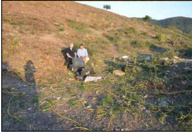
Resim 1. Çobankale sahası olası kale girişi bölgesinde Çok Elektrotlu Elektrik Rezistivite Tomografi (ERT) ölçümü
