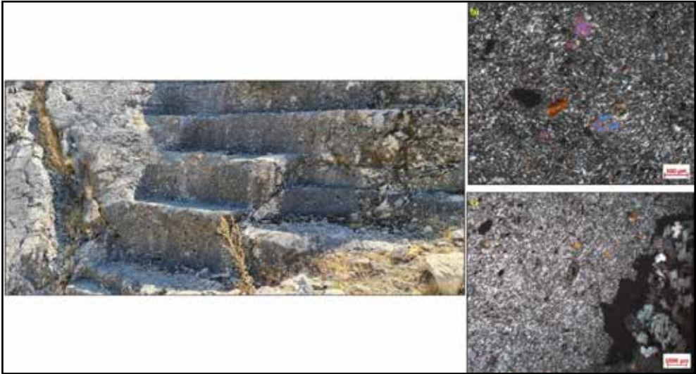
Resim 4. Trakibazalt kayasının genel görüntüsü (a), Hipohiyalin dokulu trakibazalt kayasının (b-c) mikroskobik fotoğrafı ((b-c) Çapraz Nikol)).
