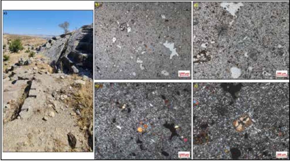
Resim 3. Karalar-Asarkaya duvar yapılarında bulunan trakibazalt kayalarının makroskobik görüntüsü (a) yapıtışı olarak kullanılan hipohiyalin ve traktitik dokulu trakibazalt kayasının (b-e) mikroskobik fotoğrafları (b-d) Paralel Nikol, (c-e) Çapraz Nikol).
