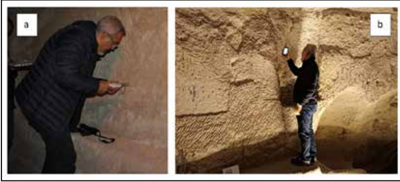
Şekil 4. (a) Tokalı Kilisesi içinde gerçekleştirilen iğne penetrometresi deneyi (b) süreksizlik özelliklerini belirlemeye yönelik çalışmalar
