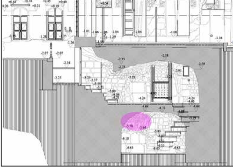
Şekil 1. Antakya Habibi Neccar Camisi'nin Türbe bölümüne ait katların planı (Plan: MNK Restorasyon Ltd. Şti.). Caminin kuzeydoğu bölümünden zeminin 5,5 metre altındaki mezar odasının mor daire ile işaretli kısmından örnekleme yapılmıştır.
