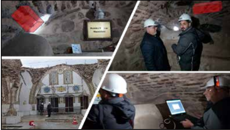
Şekil 2. Örnek Seçimi ve Değerlendirme. İşaretli bölgelerden numune alınmıştır. Sol üst resimde Habibi Neccar'ın mezarı baş kısmı ve tonozdan örnekleme yapılan yer gösterilmektedir. Sağ üst resimde örnekleme yapılan mezarın üstündeki bölge geniş açıdan gösterilmektedir. (Solda Prof. Dr. Ali Akın AKYOL ve yanında Doç. Dr. Eren ŞAHİNER). Sol alt resimde 6 Şubat 2023 tarihinde meydana gelen Kahramanmaraş depremlerinden ciddi hasar alan caminin harım bölümü gösterilmektedir. (Önde ölçüm yapan Prof. Dr. Yusuf Kağan KADIOĞLU ve arkasında not tutan Doç. Dr. Eren ŞAHİNER). Sağ alt resimde mezarın alt tarafı gösterilmekte ve yerinde GPR ölçüm işlemi yapılırken görüntülenmiştir. (Solda Doç. Dr. Eren ŞAHİNER yanında Prof. Dr. Yusuf Kağan KADIOĞLU)
