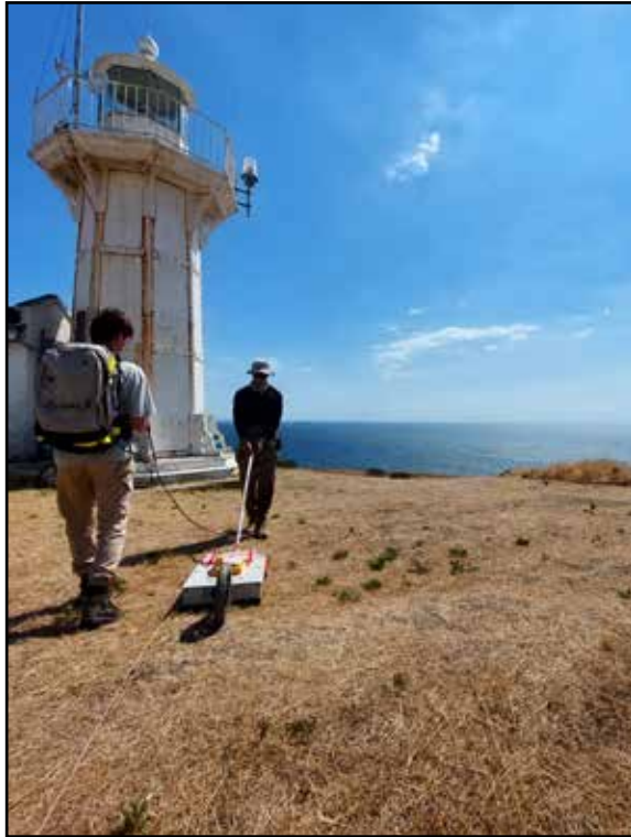
Resim 2. Saha çalışması (250 MHz'lık kapalı anten ile alınan ölçümler)
