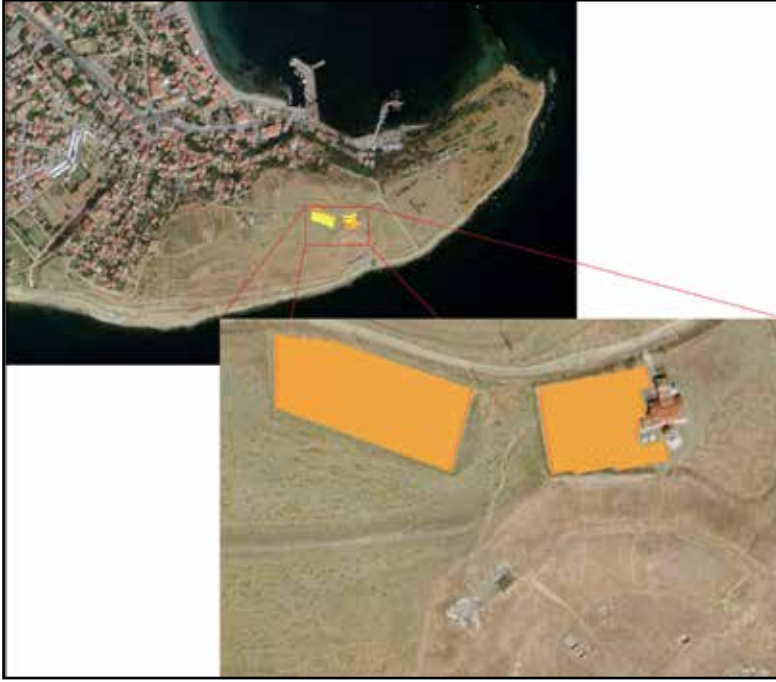
Resim 3. Yer Radarı (GPR) profilleri ve konumu (turuncu çizgiler; profiller arası mesafe 0,5 m'dir.)
