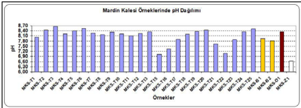
Şekil 9. Mardin Kalesi sur duvarlarına ait taş, tuğla, toprak ve kalker tabakası örneklerinde pH dağılımı
