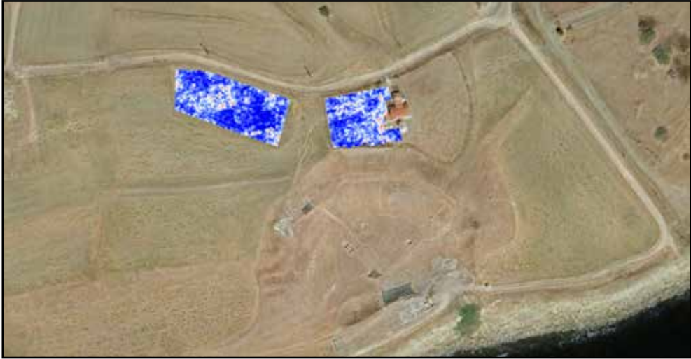
Resim 4. GPR zamansal seviye haritası (1,2 m derinlik; beyaz-pembe-kırmızı geçişli bölgeler anomalilere işaret etmektedir).
