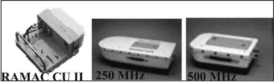
Resim 1: Çalışma alanında yer radarı verisi toplamak için kullanılan RAMAC CI II sistemi ve kapalı antenler.
