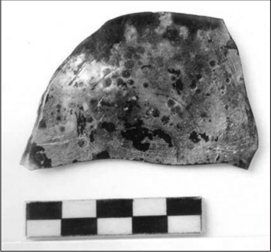
Şekil 3: Bozulma noktaları olan bir cam örneği.
