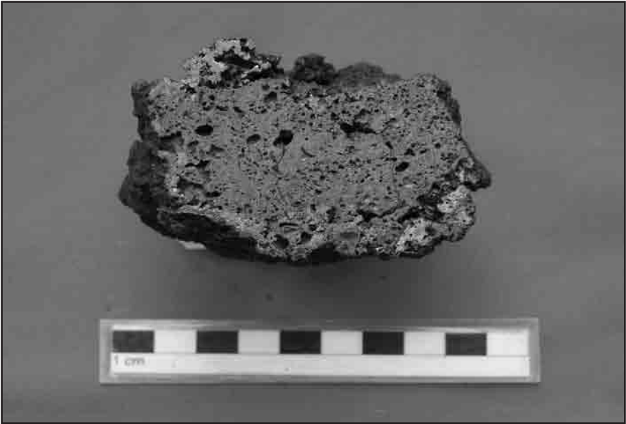
Resim 8: DPC türü demirci ocağı cürufunun kesiti
