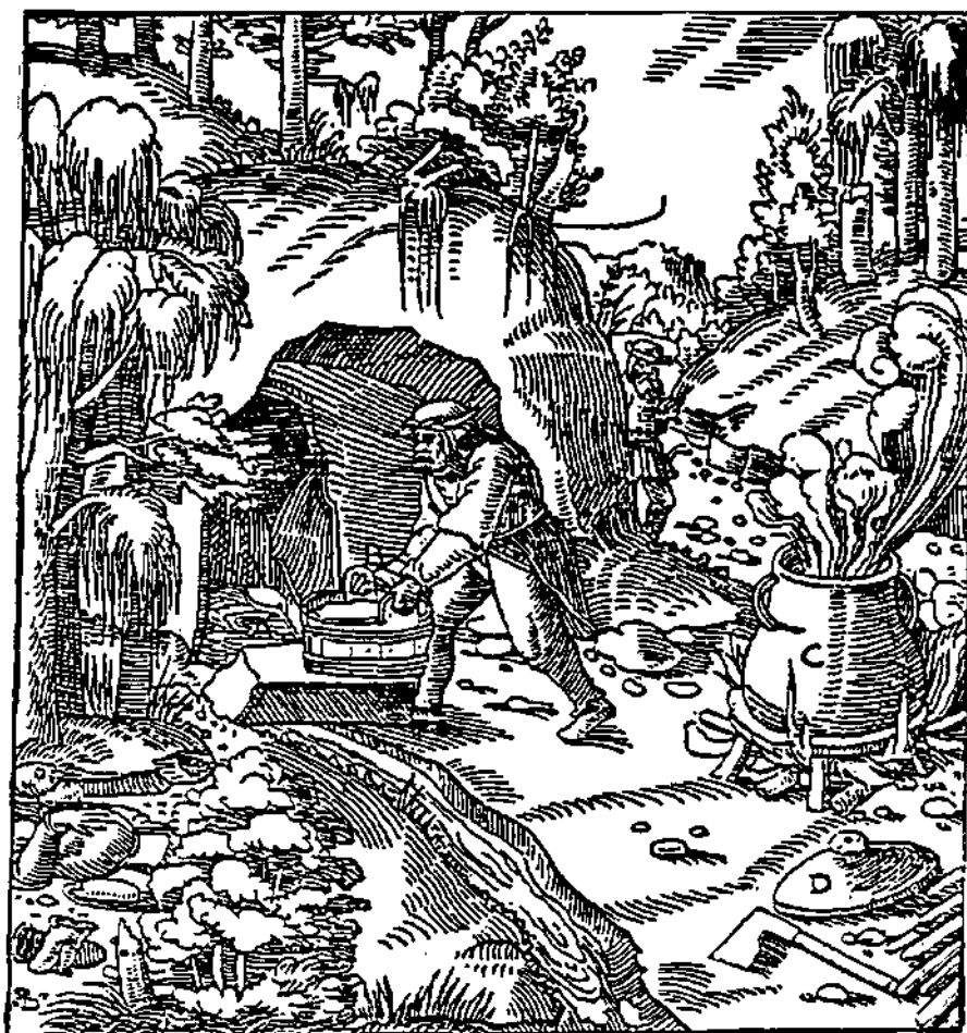
Resim: 1- Asfaltın elde edilmesi (Agricola'dan) A. Bitumen içeren kaynak, B. Tekne, C. Bakır veya demirden kazan, D. Kapak
