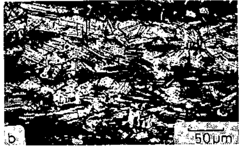
Resim : 6 — Mızrak ucu (I/85-45) kesici ağız kısmının mikro yapısı.
