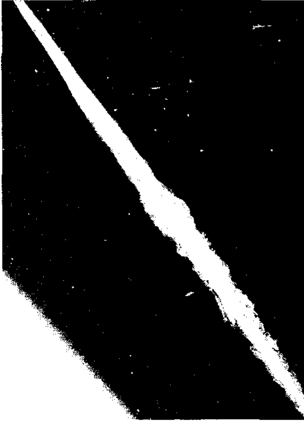
Resim : 3 — (83/173 Env. No. 1u) Kamanın X-ışını ile yandan alınan radyografı
