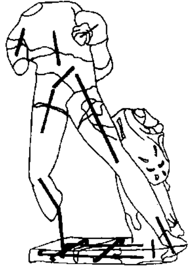
Resim : 11 — Satyr heykeli- nin onarım- da yerleşt- rilen me- tal çu- bukla- rın yer- lerini gös- teren çizim.
