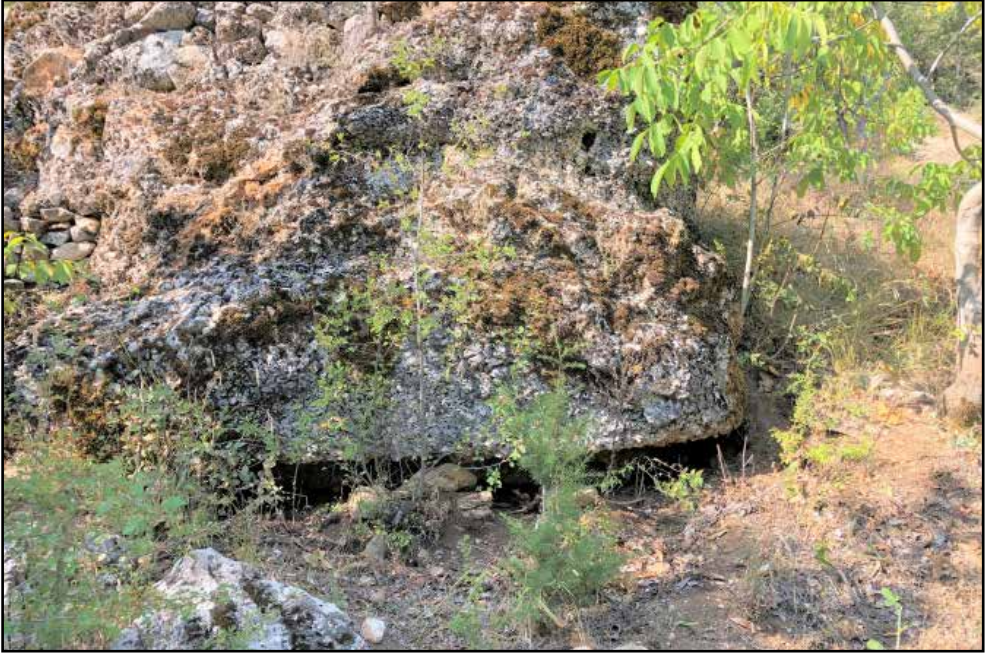
Resim 12: Yeşilbaşköy Traverten Taş Ocakları, bloğun alttan kesilmesi yoluyla taş çıkartma işlemi için hazırlanan traverten.
