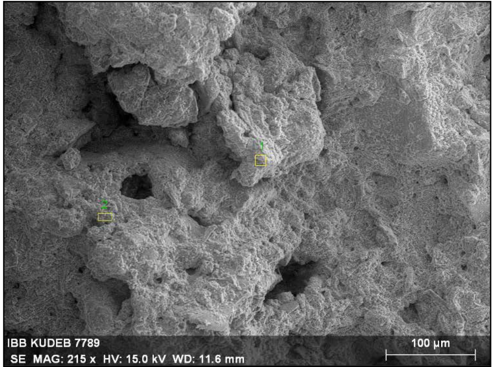
Resim 5: Harç Örneği SEM Görüntüsü.
