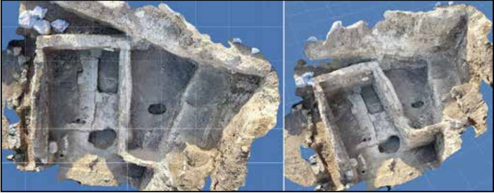
Resim 1: Lysimakhos Evi Olarak Tanımlanan Kazı Alanının LiDAR Sensörlü Tablet Bilgisayar ile Elde Edilen Taramasının Renklendirilmiş Nokta Bulutu. Kazı Alanının ReCAP Programı ile Perspektifli ve Perspektifsiz Olarak Görünüşü.
