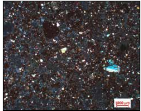
Resim 8: Habibi Neccar Camisi'nde Kullanılan Tuğla Örneğinin (a) Paralel Nikol, (b) Çapraz Nikol Mikrofotografı.
