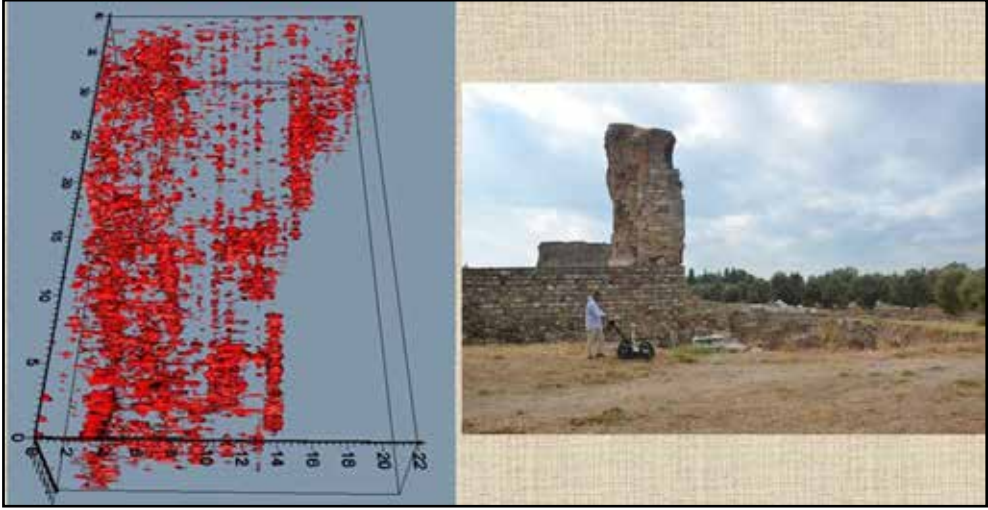
Resim 6: Aydın İli, Tralleis Antik Kenti, Bölge-1'de GPR ölçülerinden oluşturulan üç boyutlu (3D) Küp Model, güneyden kuzeye bakış, Jeoradar Görünümü ve alanda ölçü alınması.
