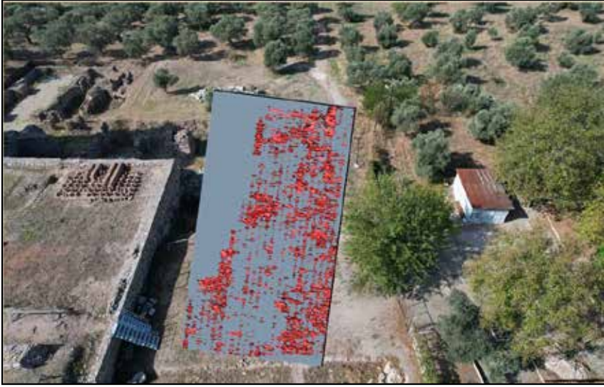
Resim 8: Aydın İli, Tralleis Antik Kenti, Bölge-1’de GPR ölçülerinden oluşturulan, üstten bakış, üç boyutlu (3D) Küp Model Jeoradar Görünümünün, gymnasium, portiko ve dükkanların devamı olabileceği düşünülen çalışma alanının, hava fotoğrafında gösterimi..
