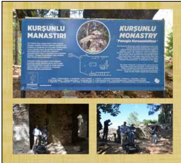
Resim 1: Aydın İli Kuşadası İlçesi Davutlar Güneyi Mykale (Dilek / Samsun) Dağı, Kurşunlu Manastır Kompleksi Kilise Kalıntısı İçinde ve Çevresinde GPR Ölçüm Çalışmaları.
